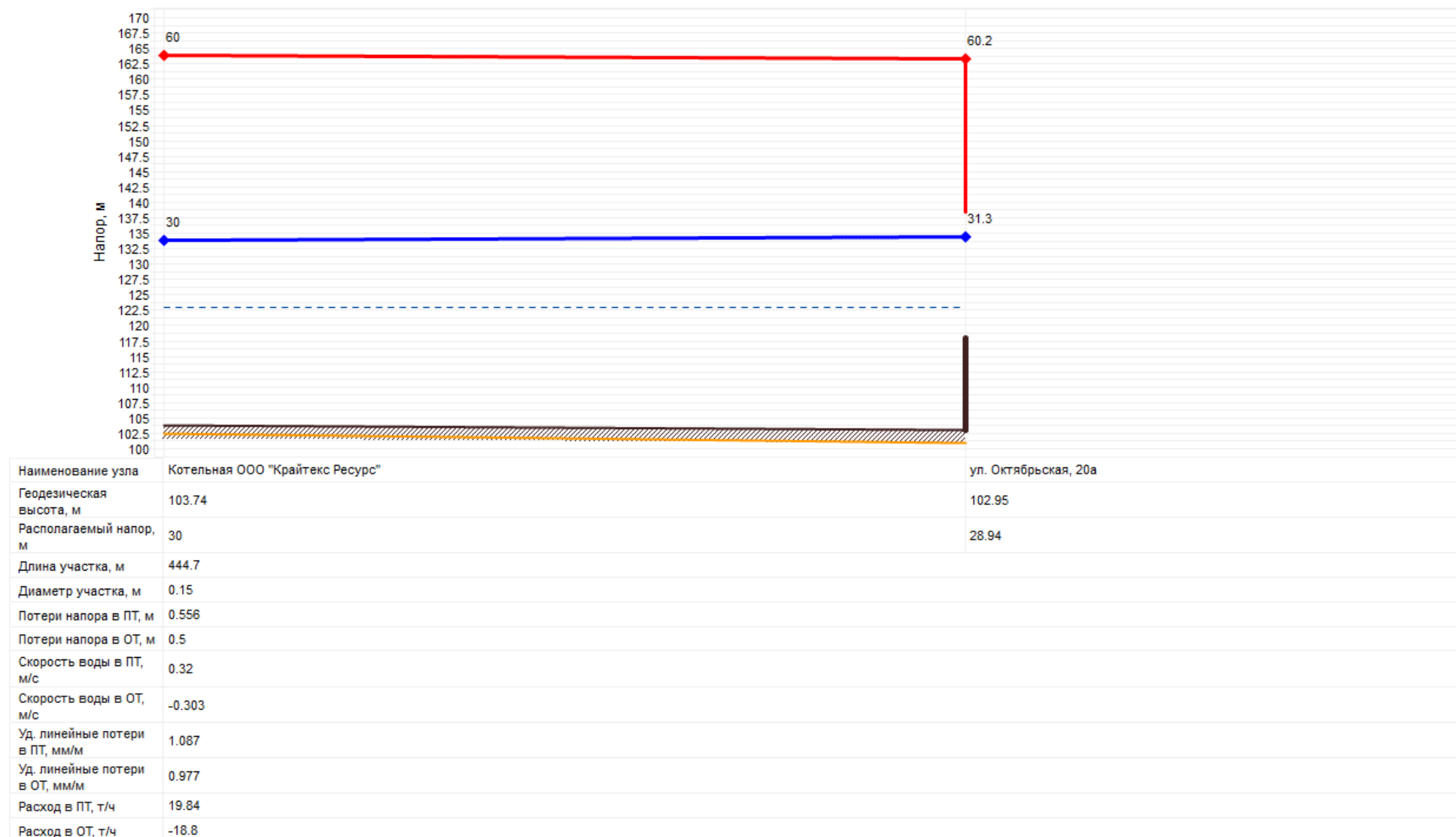
Рис. 13.4 Пьезометрический график от котельной ООО «Крайтекс Ресурс» до конечного потребителя ул. Октябрьская, 20а
