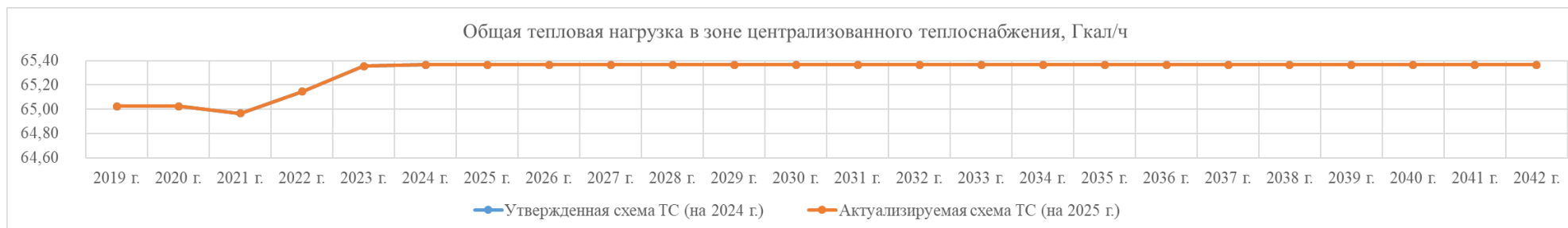
Рис. 1.5. Сравнение общей тепловой нагрузки в зоне централизованного теплоснабжения актуализируемой (на 2025 г.) схемы теплоснабжения с актуализированной ранее схемой теплоснабжения (на 2024 г.)
